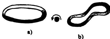
Obr. 2. Pryžový těsnicí O-kroužek a) v základním rovnovážném stavu a b) v pseudorovnovážném stavu po překroucení naznačeným způsobem.
