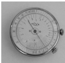
Obrázek 9: „Kruhové“ logaritmické pravítko (původem ze Sovětského svazu)
