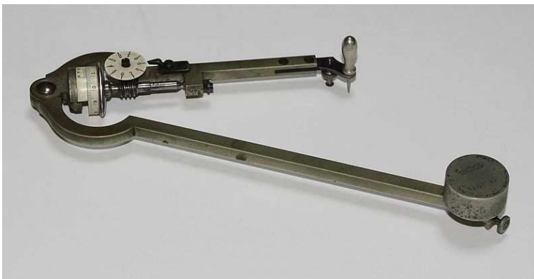
Obr. 7. Planimetr – přístroj na měření plochy (zdroj: WikimediaCommons)
