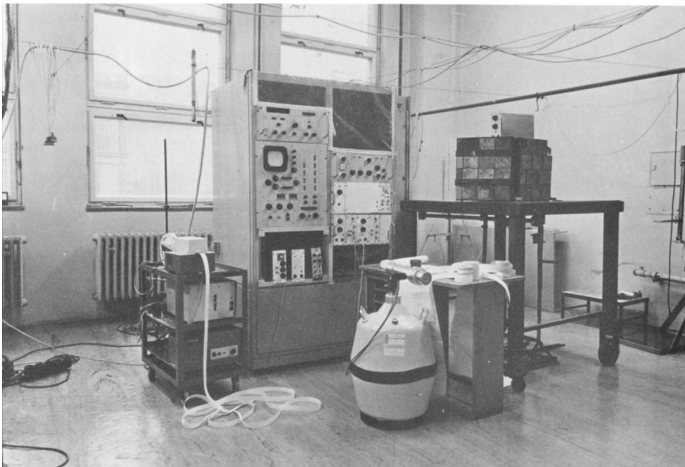
Obr. 4. Spektrometr záření gama pro měření spekter gama s použitím Ge(Li) detektorů.
